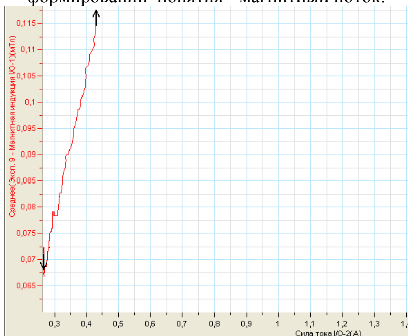
Рисунок 3 «График линейной зависимости магнитной индукции от силы тока в проводнике»
