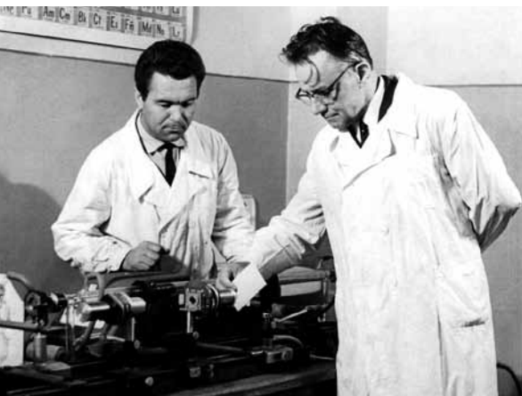
В.Ф. Плохих и М.М. Носков у самодельного газового лазера на углекислом газе, 1968 г.
